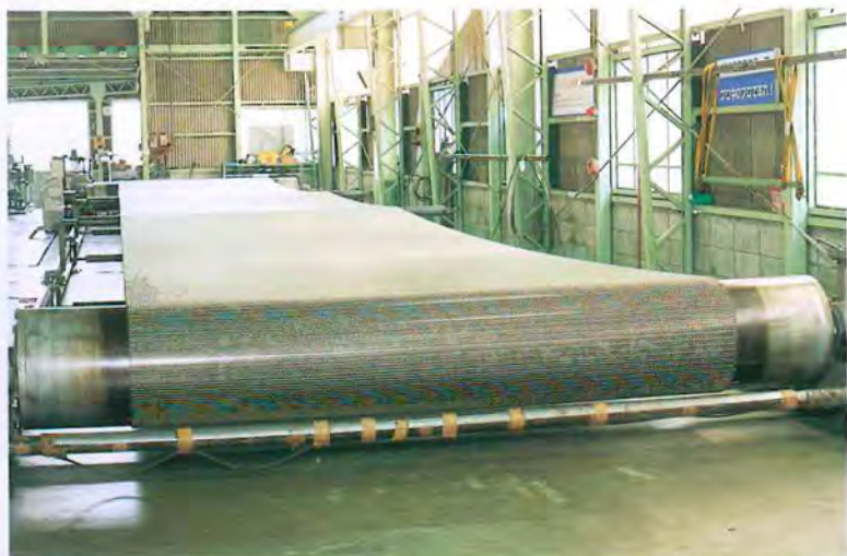
有効幅3,000mm×長さ50mストレッチ (ロードセル付) Stretch machine (width 3,000 mm, length 50 m) (with load cell)
